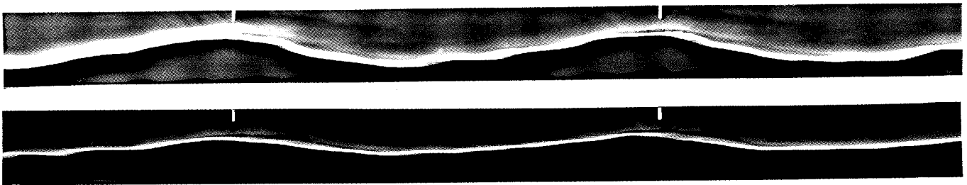
Fig.2: Schlieren-Streak-Aufnahmen des instationären Stoßes im Gitterelement ohne (oben) und mit Ventilation (unten), Frequenz f = 60 \text{ Hz} , M_1 = 1.3 , p_2/p_1 = 1.75 , Sehnenlänge c = 187.4 \text{ mm} , Kammerlänge l_c = 0.32 c
