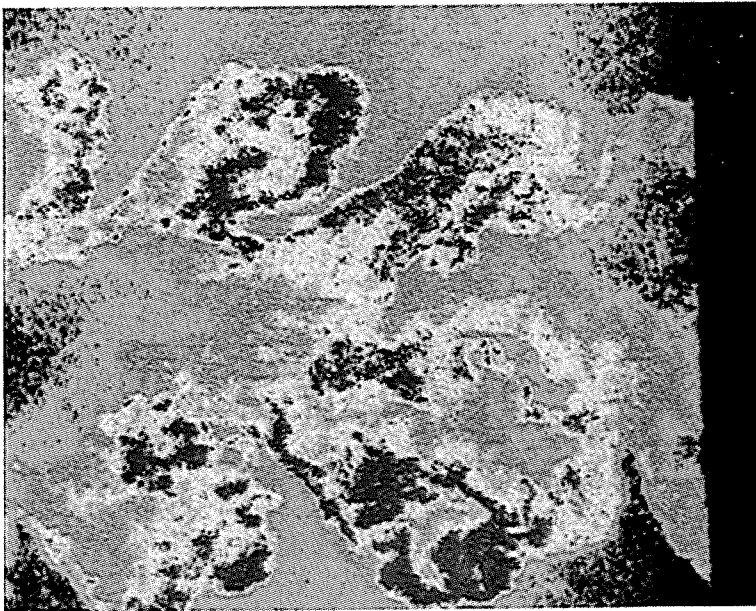
Abbildung 1: Single-shot OH-LIF Image innerhalb der Staustahl Brennkammer (Strömungsrichtung von links nach rechts)
