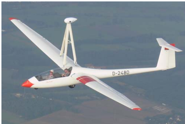
Abb.1: Segelflugzeug Janus mit modifizierter Flügeloberfläche (rot) und Infrarotkamera
