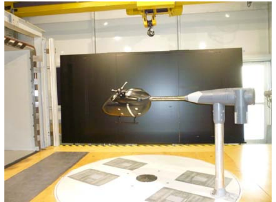
Abbildung 2: Windkanalmodell mit Befestigung am Ausleger (Befestigungsvariante 2)
