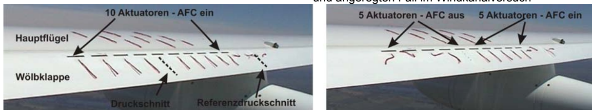
Abbildung 3: Strömungsvisualisation mit Wollfäden im Flugversuch - Bild links: 10 Aktuatoren eingeschaltet; Bild rechts: 5 Aktuatoren ausgeschaltet sowie 5 Aktuatoren eingeschaltet
