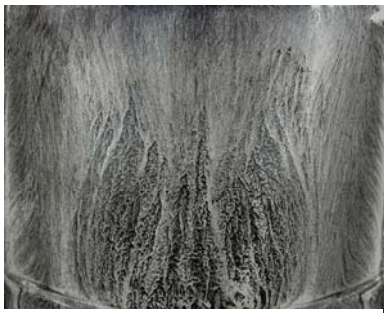
Abbildung 1: Strömungsvisualisierung mittels Öl-Ruß Anstrichverfahren
