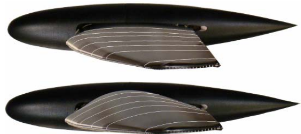
Abbildung 5: Draufsicht des verformten Flügels (Segelkonfiguration) bei 135Pa (oben) bzw. 540Pa (unten), \alpha=10^\circ
