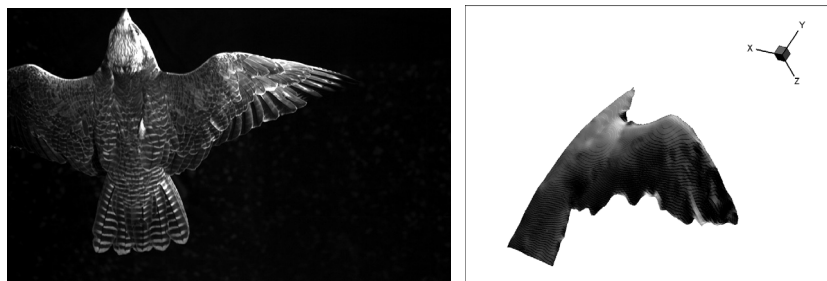
Abbildung 2: Entzerrte und segmentierte Aufnahme (links), berechnete Höheninformation der Oberfläche (rechts) eines Lannerfalken im Schlagflug
