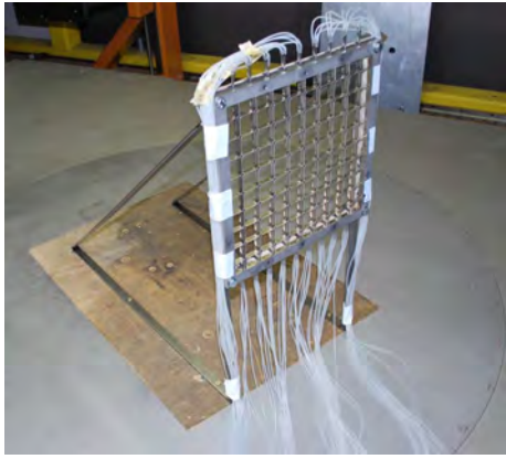
Abbildung 2: Versuchsaufbau zur Bestimmung der Winkelunabhängigkeit
