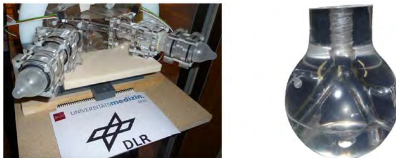
Abbildung 1: Modelle für LDA-Untersuchungen. (links): generische Bifurkation mit Membraneinheit zur Einstellung der Lungencompliance. (rechts): transparentes SilikonelastomermodeLL der Lunge (4. Generation)
