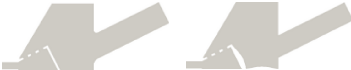
Abb.1 : Ausgangsgeometrie des Kabinenluftauslasses (links), Verformte Geometrie des Kabinenluftauslasses (rechts).
