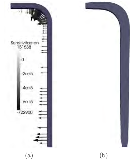
Abbildung 1: Berechnete Sensitivitäten an den Berandungen eines Kanalkrümmers: a) Verteilung der Sensitivitäten entlang der Unterseite des Kanals, b) Verformte Geometrie des Kanals nach 12-maliger Iteration
