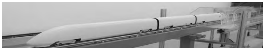
Abbildung 1: Generisches ICE3-Zugmodell im TSG bei der Fahrt von links nach rechts in einen Modelltunnel mit Portalhaube
