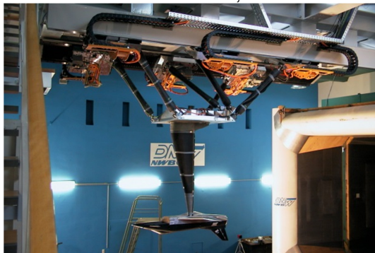
Abbildung 1: Modell der X-31 am MPM im DNW-NWB
