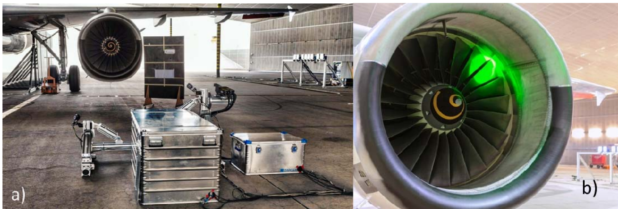
Abb. 1 IPCT Aufbau vor dem Triebwerk des Airbus A320 DLR-ATRA (a) und Fan mit projiziertem Muster (b)
