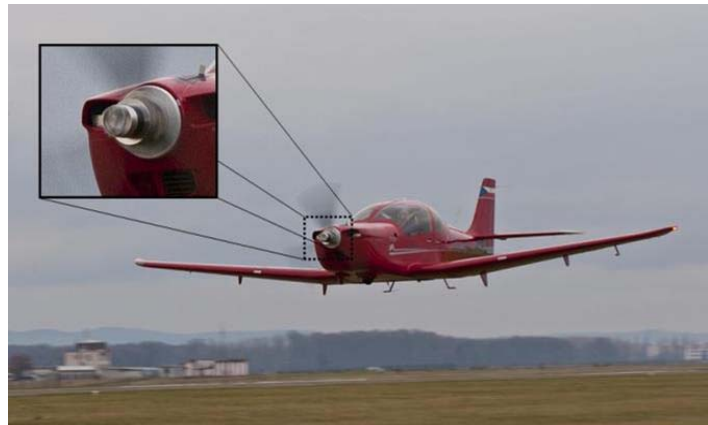
Abbildung 2: EVEKTOR VUT-100 COBRA mit montierter rotierender Kamera (vergrößertes Detail)
