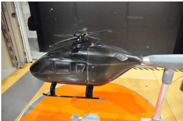
Abbildung 1: Hubschrauberkonfiguration im Windkanal (links); Hubschrauberkonfiguration für numerische Simulationen (rechts).
